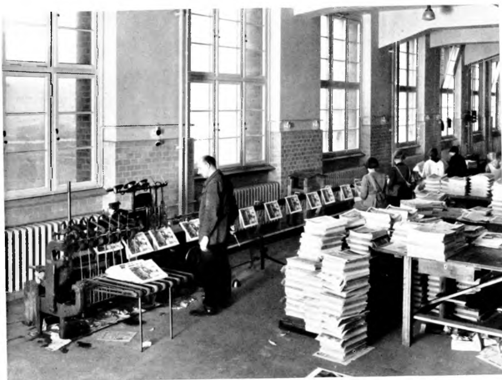
Abb. 170. Automatische Rückenheftmaschine. Die gefalzten Bogen werden auf dem laufenden Band zum Heftapparat geführt
