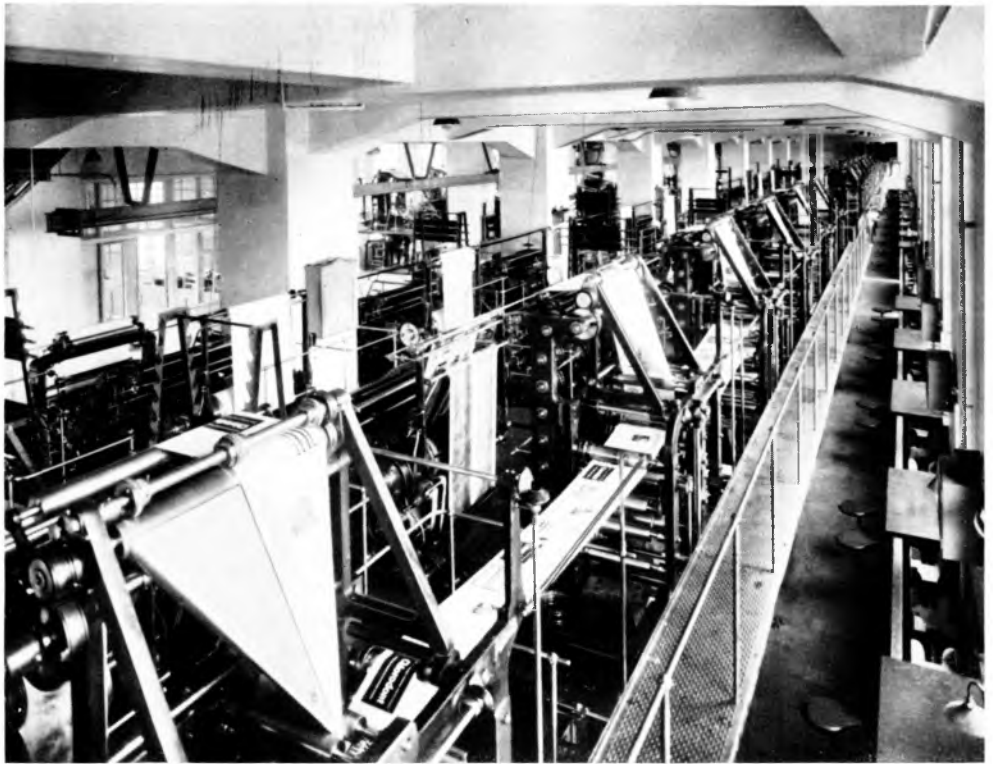
Abb. 176. Blick auf die Reihenrotationsmaschinen. Rechts Förderband
