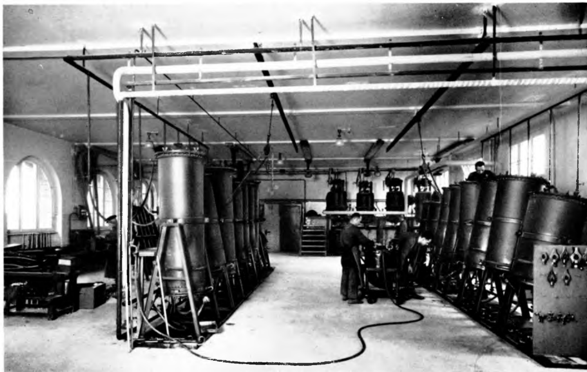
Abb. 163. Walzengießerei. Links und rechts die Formen zum Gießen der Walzen; im Hintergrund die Kessel zum Kochen der Walzenmasse
