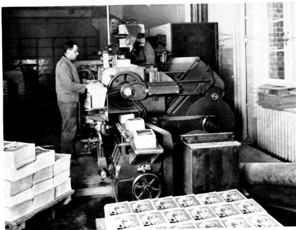
Abb. 171. Seybold-Schneidemaschine zum Beschneiden von Broschüren. Die Späne werden durch das Rohr rechts abgesaugt und fallen in den Keller. Stundenleistung 8—10 000 Exemplare des „Uhu“
