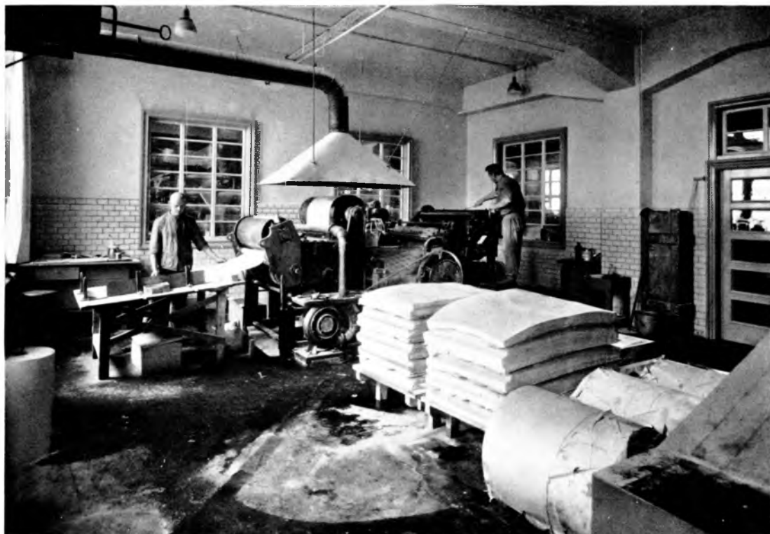
Abb. 165. Maschine zum Drucken der Abplättmuster. Die Farbe wird mit Kollophonium gestaubt; die Entlüftungsanlage dient zum Absaugen des entstehenden Staubes
