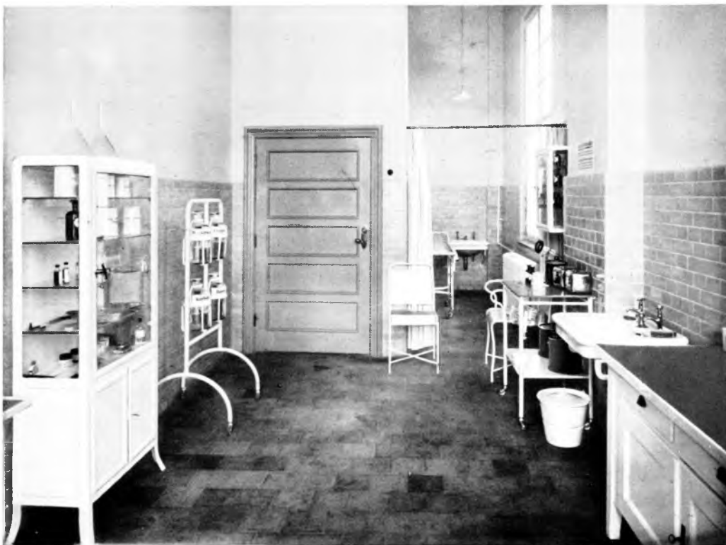
Abb. 108. Verbandszimmer. Wände mit Riemchen verkleidet, Decken und Wände in hellgelber Ölfarbe
