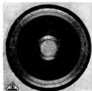
Abb. 26. Einfach-Ölkabel 220 kV, 220 000 kVA, 200 mm 2 .
