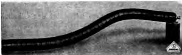
Abb. 12. 100 kV-Einfach-Ölkabel unter 90 at Innendruck.
