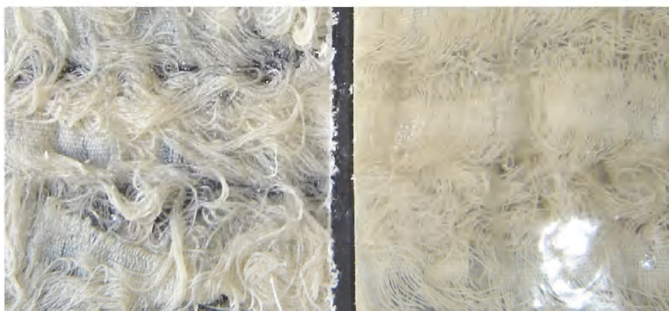
Rys. 147. Tkanina (lewa i prawa strona) z krajki pomocniczej z rys. 146a stanowiącej zbrojenie w laminacie z żywicy epoksydowej; Instytut Architektury Tekstyliów PŁ (Masajtis J.), (Szoslant J., Kabziński A.)
