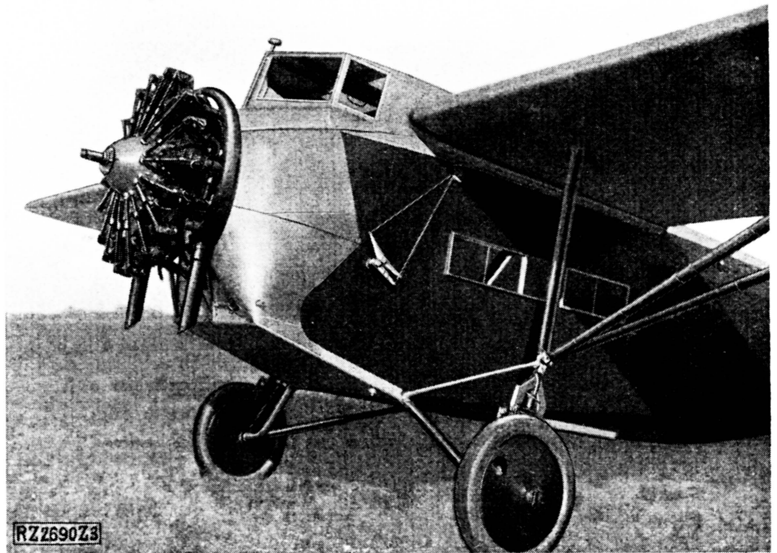
Abb. 3. Halbfreitragender Hochdecker der Arado Handels-G. m. b. H., Berlin-Warnemünde.
