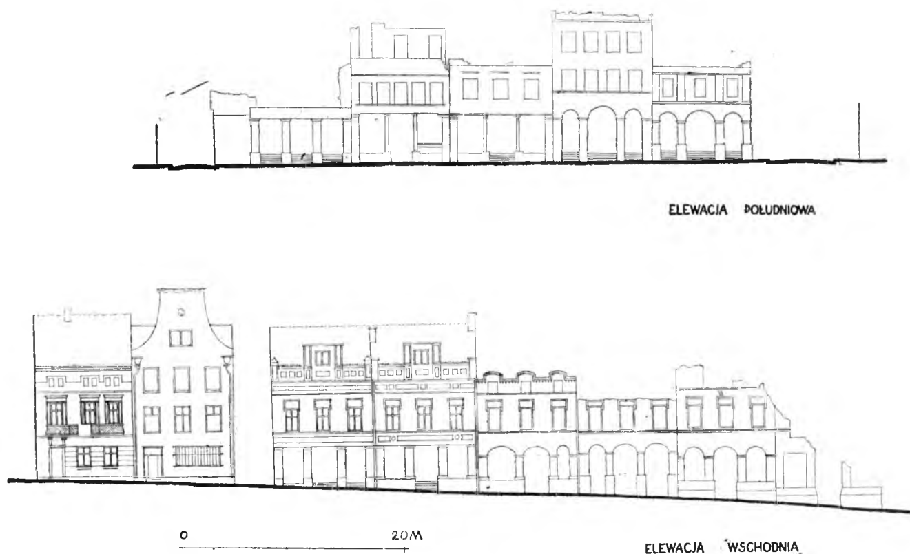
Rys. 3. Lidzbark Warm. — Elewacje ścian rynku. Zniszczenia charakterystyczne dla miast woj. olsztyńskiego. Opracowano w Zakładzie Urbanistyki P. W. podczas praktyki wakacyjnej w r. 1947. Pomiar posłużył jako podkład pod projekt odbudowy rynku.
