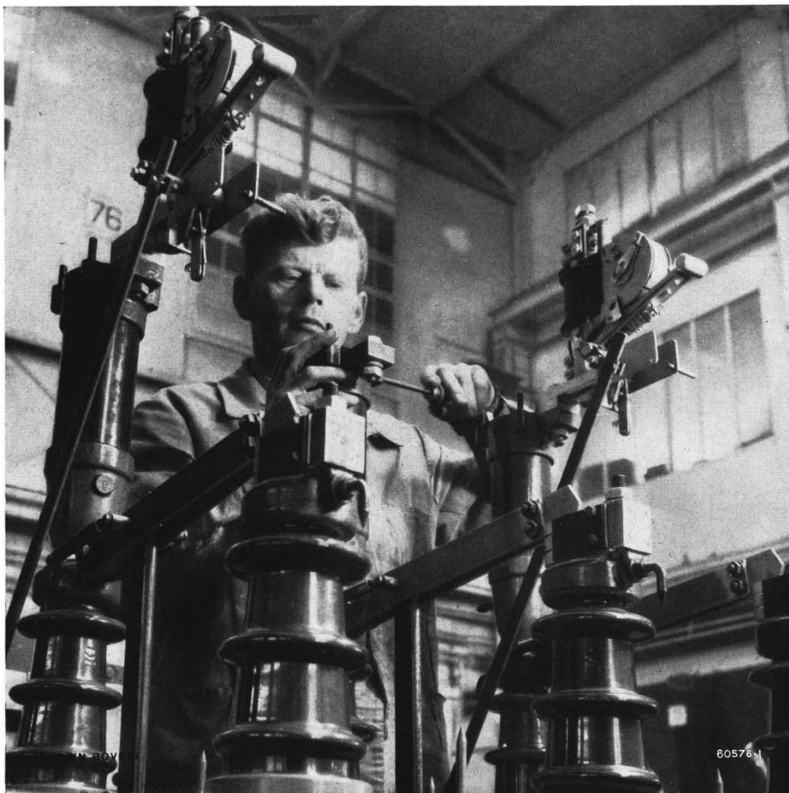
Montage d'un disjoncteur pneumatique ultra-rapide.
