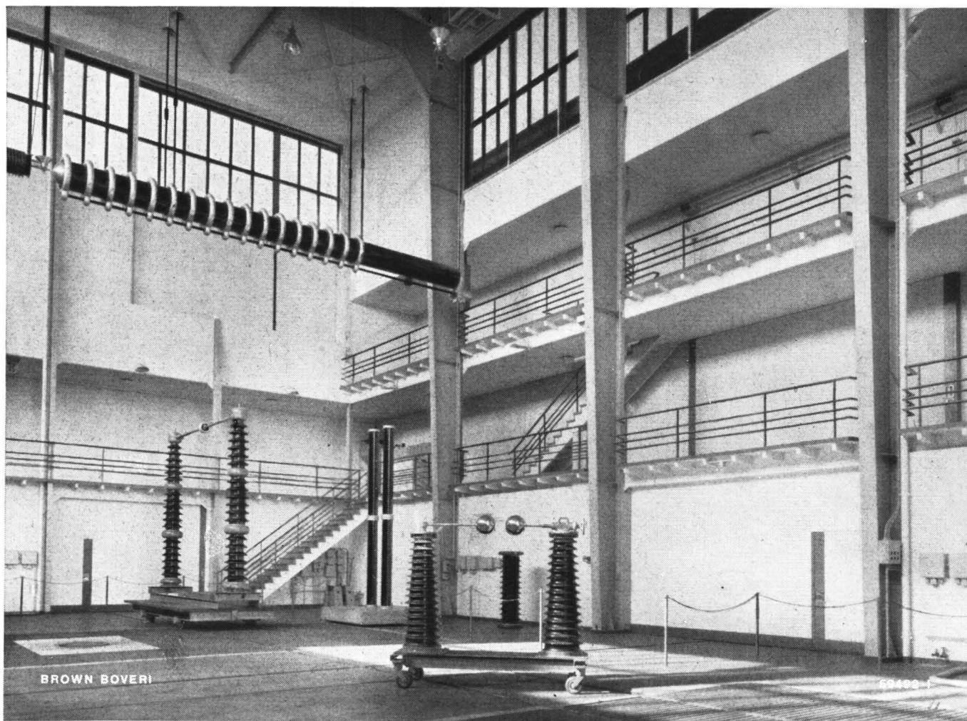
Fig. 4. — Emplacements d'essais, galeries d'observation et redresseur à haute tension dans la halle à haute tension.
