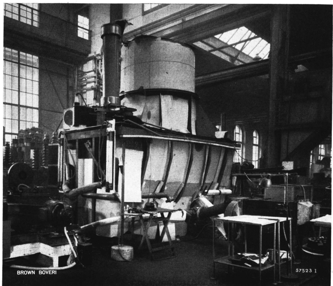
Fig. 3. — Installation d'essai pour le séchage et pour le mesurage des pertes diélectriques comme contrôle du processus de séchage.
