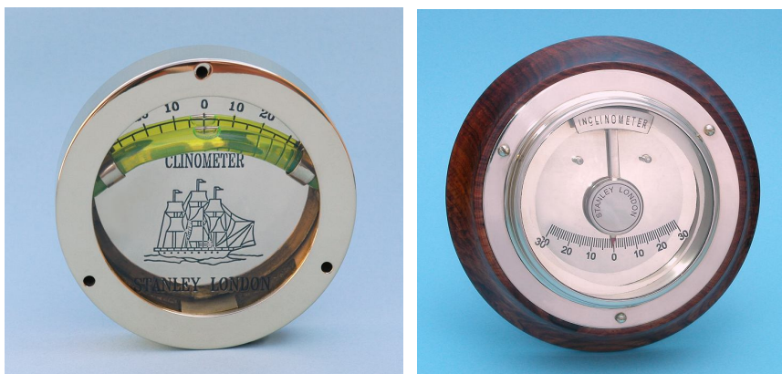
Rys. 95. Poziomnice: a) poziomnica ampułkowa; b) poziomnica wahadełkowa [S26]
