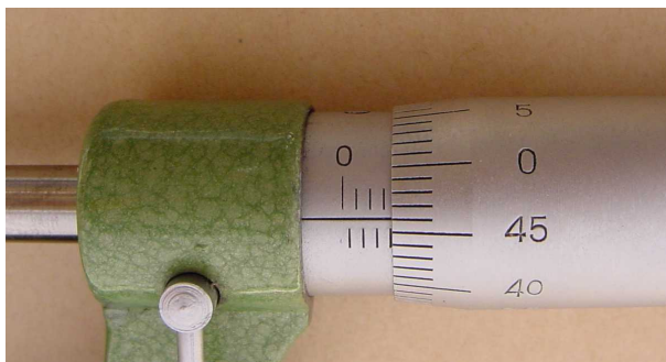
Rys. 59. Przykład wskazania mikrometru przy którym łatwo popełnić błąd półmilimetrowy (odczyt 3,96 zamiast poprawnego 3,46) [S7]
