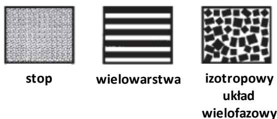
Rys. 30. Schematyczna ilustracja struktur różnych typów powłok nanokompozytowych [Hauert i Patscheider, 2000]
