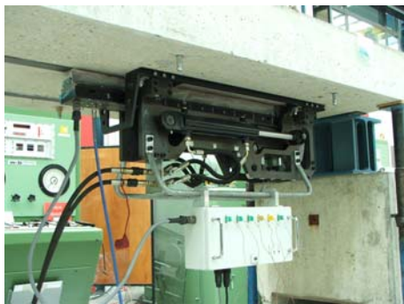
Rys. 4.7. Bezkontaktowy system naprężania ze stopniową redukcją siły naciągu w taśmie: a) schemat naprężania taśmy FRP, b) system nagrzewania taśmy, c) widok poduszki dociskowej (Kotynia i inni, 2011)
