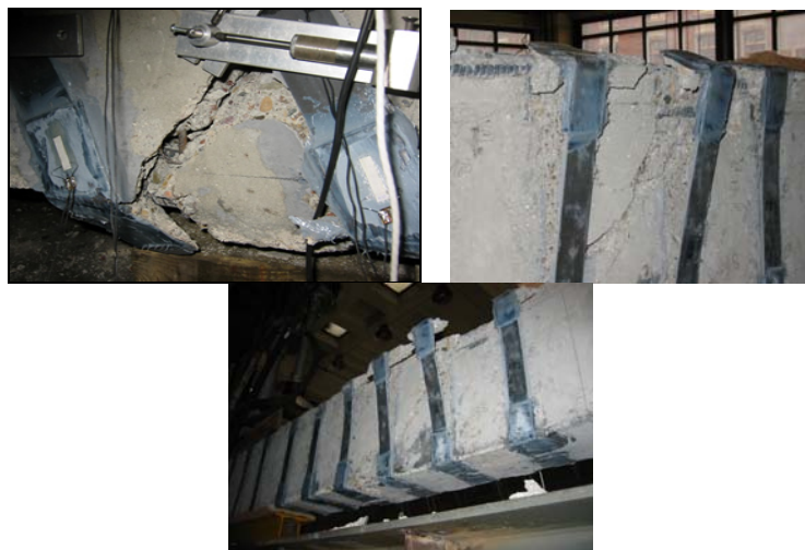
Rys. 5.43. Widok odspojonych taśm i zakotwień belek BSR-T60k i BSR-T90k
