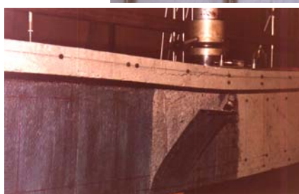
Rys. 5.37. Odspojenie maty od środника i zmiążdżenie betonu w strefie ściskanej belki BT-m
