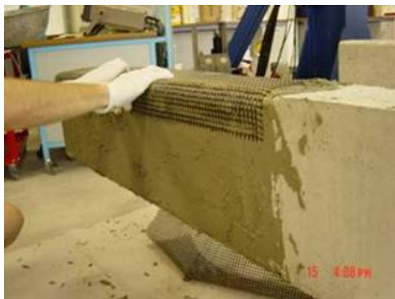
Rys.4.2. Wzmacnianie belki żelbetowej przy użyciu zaprawy ze spoiwem nieorganicznym (Triantafillou i Papanicolaou, 2006)
