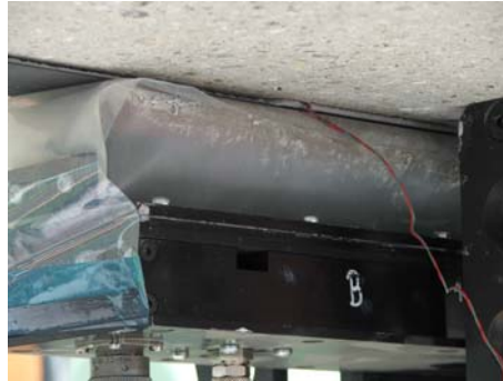
Rys. 4.7. Bezkontaktowy system naprężania ze stopniową redukcją siły naciągu w taśmie: a) schemat naprężania taśmy FRP, b) system nagrzewania taśmy, c) widok poduszki dociskowej (Kotynia i inni, 2011)
