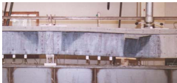
Rys. 5.36. Usytuowanie tensometrów elektrooporowych na powierzchni taśm
