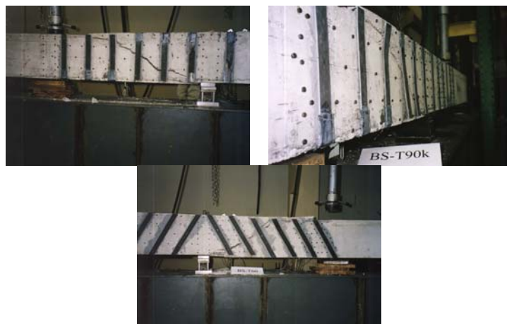
Rys. 5.42. Obraz rys niszczących w belkach BS-T90K i BS-T60
