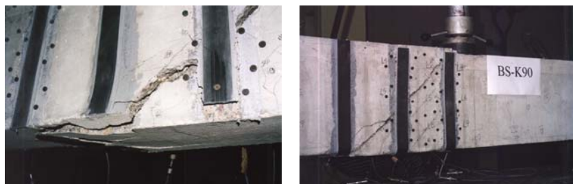
Rys. 5.41. Odspojenie strzemion kompozytowych w belkach BS-T90, BS-T90K i BS-90
