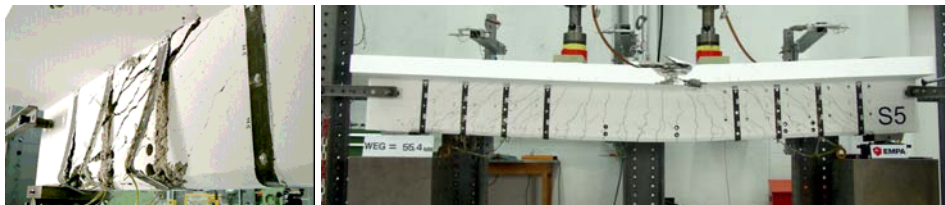
Rys. 5.26. Sposób zniszczenia belki S3 i S5 (Czaderski i Motavalli, 2004)
