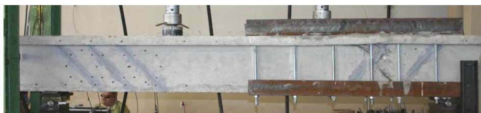
Rys. 11.9. Sposób wzmocnienia jednej z podpór po zniszczeniu na ścinanie (Kotynia, 2007)
