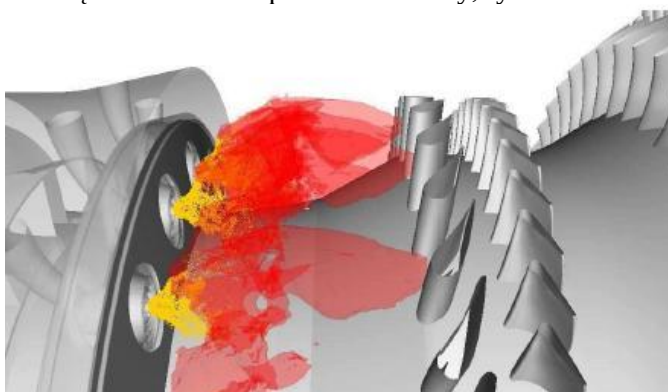
Rys. 2.28. Niejednorodność pola temperatury na wylocie z komór spalania [Medic et al., 2006]
