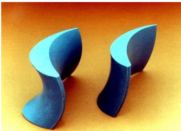
Rys. 4.7. Przestrzennie kształtowane łopatki, tzw. "szabl kształtne", pierwszej kierownicy o większej i mniejszej krzywiznie
