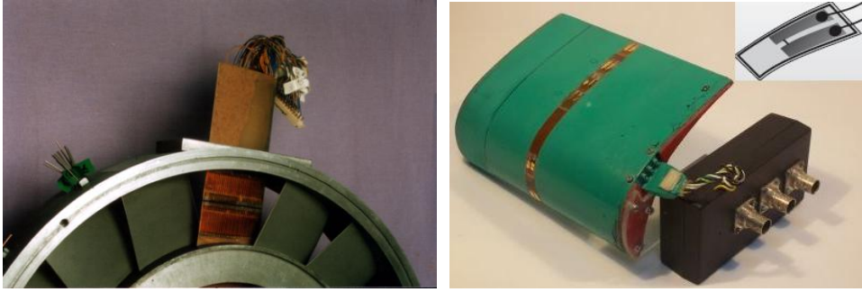
Rys. 4.15. Przetworniki termooanemometryczne foliowe do badań warstw przyściennych
