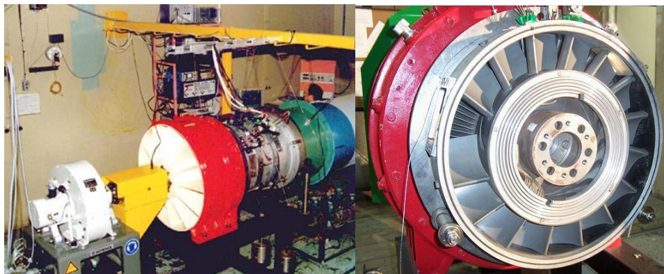
Rys. 4.2. Ogólny widok dwustopniowej turbiny modelowej oraz wlot do drugiej kierownicy turbiny TM3-00
