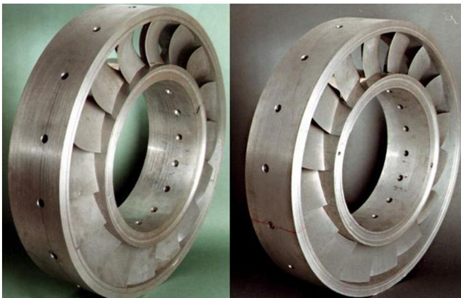
Rys. 4.8. Wykonane kierownice z łopatkami przestrzennie kształtowanymi, tzw. „szablokształtnymi” o większej i mniejszej krzywiznie
