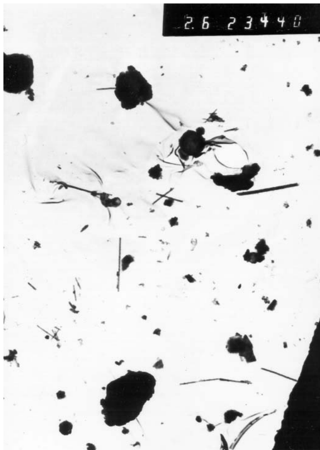
Ryc. 1. Obraz z transmisyjnego mikroskopu elektronowego prób pyłu pobranych na filtr z powietrza w środowisku wsi Ogorzelec (szkoła).
