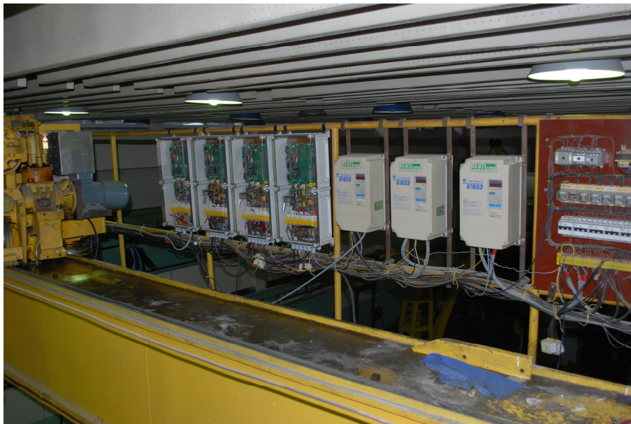
Fot. 5.3. Układ sterowania suwnicy eksperymentalnej
