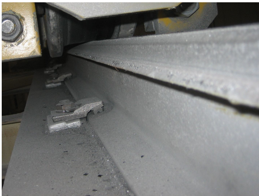
Fot. 6.1. Powierzchnie boczne główek torów oraz obrzeża kót
