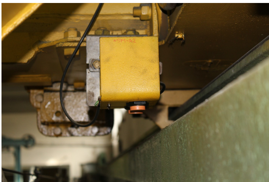
Fot. 5.7. Zestaw czujników korekcji położenia lewej czołownicy
