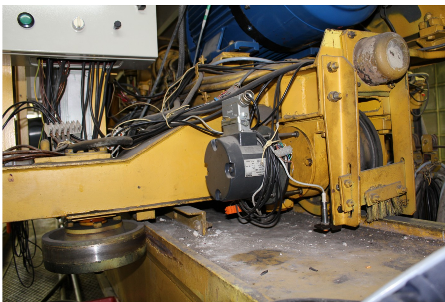
Fot. 5.5. Przetwornik sprzężony z kołem nienapędzanym wózka
