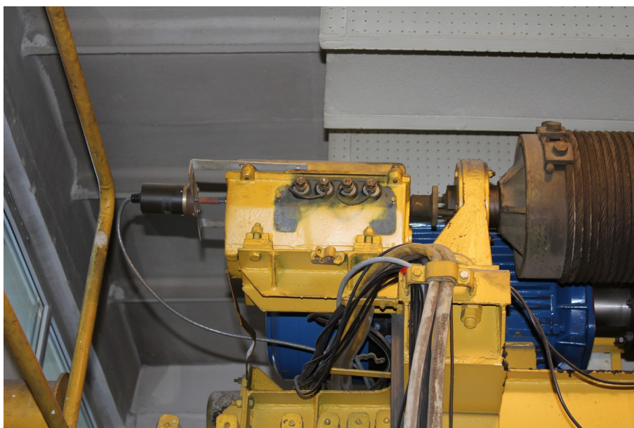
Fot. 5.9. Czujnik obrotowo kodowy na wale bębna wciągarki
