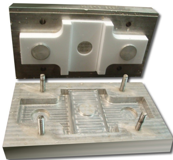
Rys. 5.16. Forma produkcyjna do wytwarzania styropianowego modelu wspornika. Odlew z żeliwa EN-GJS-400-15.
