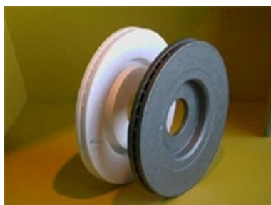
Rys. 4.40. Fotografia modelu styropianowego tarczy hamulcowej oraz gotowego odlewu.
