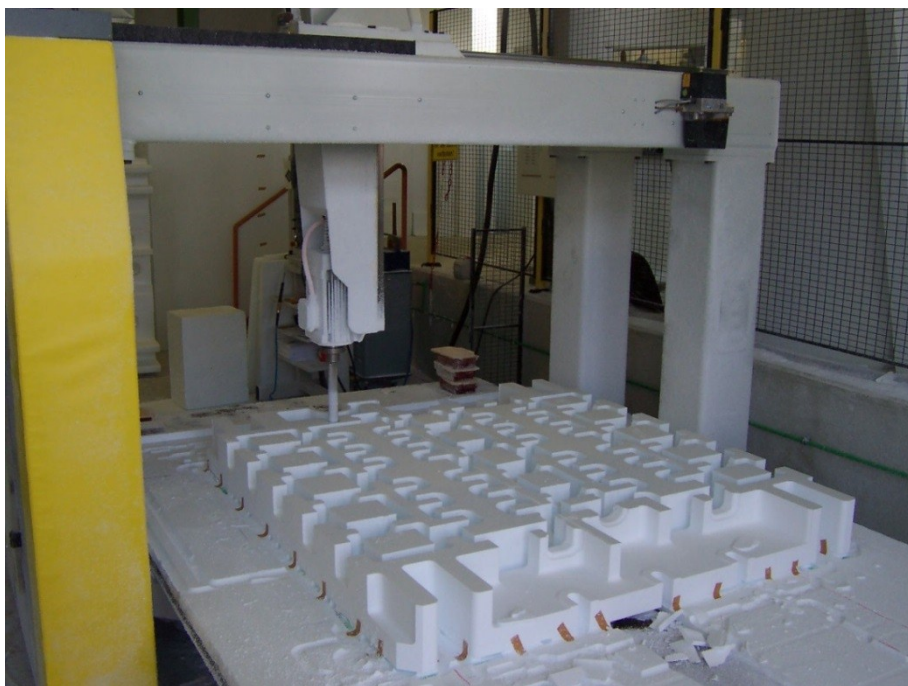
Rys. 4.34. Obróbka dużych modeli styropianu na obrabiarce CNC z wykorzystaniem narzędzi skrawających.
