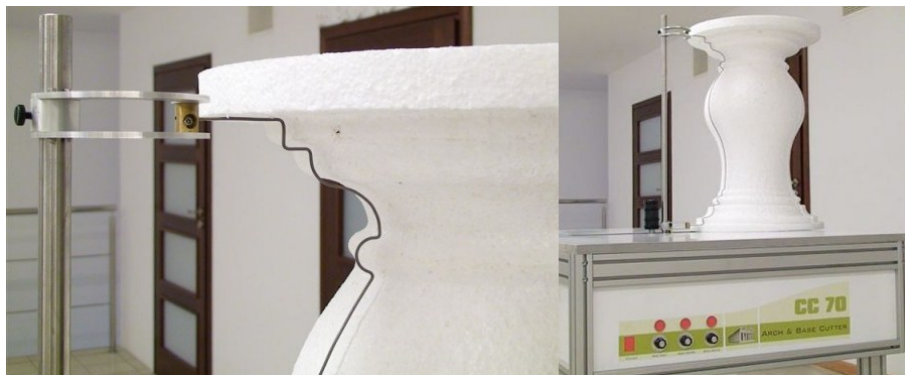
Rys. 4.32. Wycinanie modeli styropianowych na ploterze termicznym za pomocą drutu kształtowego [61].
