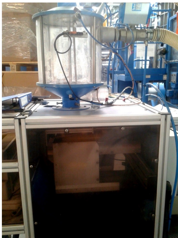
Rys. 4.5. Stanowisko kontroli czynnej gęstości nasypowej styropianu.
