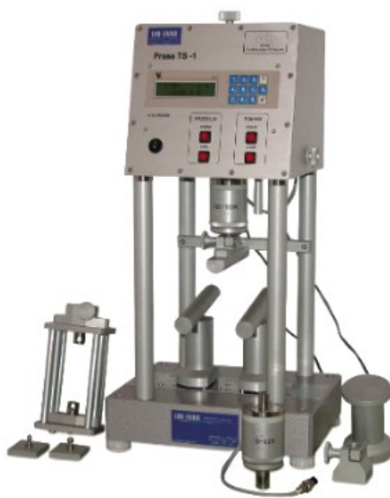
Rys. 4.28. Aparat TS-1 do badania wytrzymałości na zginanie.
