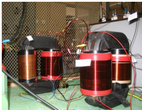
Rys. 4.4. Model fizyczny przekładnika kaskadowego dwurdzeniowego ( U_{pn} = 1 \text{ kV} )
