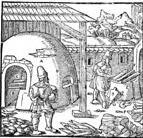
Rys. 1. Polski i węgierski piec do otrzymywania srebra z ołowiu srebronośnego przez wypalanie według Agricoli. A — piec, B — uliczka, C — ruszt żelazny, D — otwór roboczy do spuszczenia glejty, E — trzon bez pokrywy, F — grube bierwiona drzewa, G — miech.
