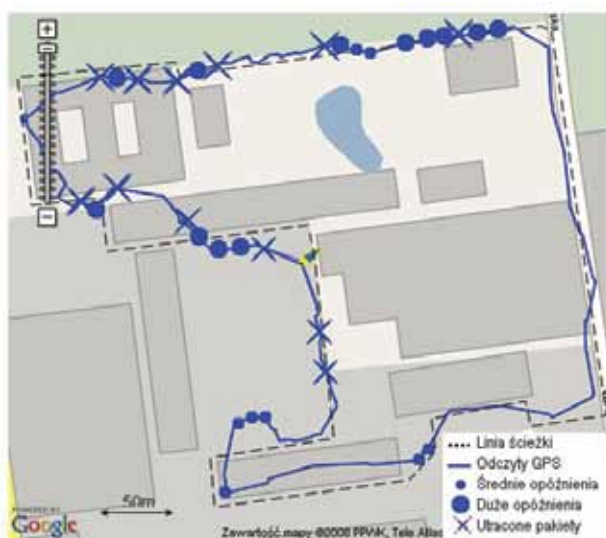
Rys. 5.22. Ocena parametrów transmisji sekwencji obrazów wykonana dla testów systemu nawigacji dla osoby niewidomej przy pomocy zdalnego przewodnika; średnie opóźnienia oznaczają opóźnienie transmisji obrazu o ok. 200 ms, a duże o ok. 1000 ms; wyniki uzyskane w roku 2008 (zob. legenda mapy)
