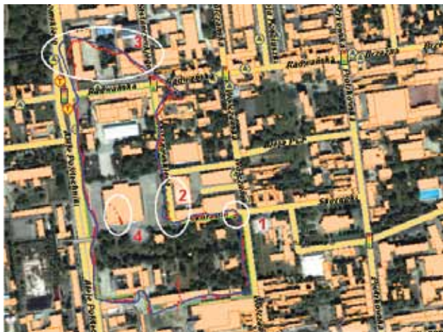
Rys. 3.20. Zastosowanie filtracji Kalmana do estymacji położenia geograficznego na podstawie odczytów GPS; kolory linii na obrazie mapy oznaczają: jasno zielony – ścieżka marszu, czerwony – odczyty współrzędnych GPS, niebieski – estymacja położenia z zastosowaniem filtra Kalmana
