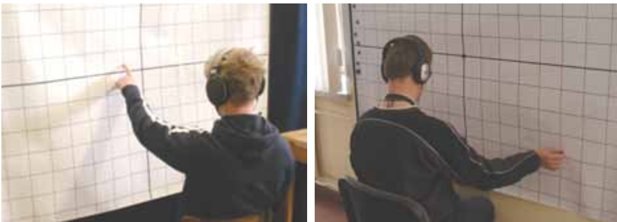
Rys. 4.16. Test lokalizacji; osoby niewidome wskazują położenie wirtualnego źródła dźwięku
