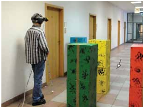
Rys. 5.15. Test przejścia trasy z rozmieszczonymi przeszkodami i odszukaniem obiektu odtwarzającego melodię (wskazanego strzałką)
