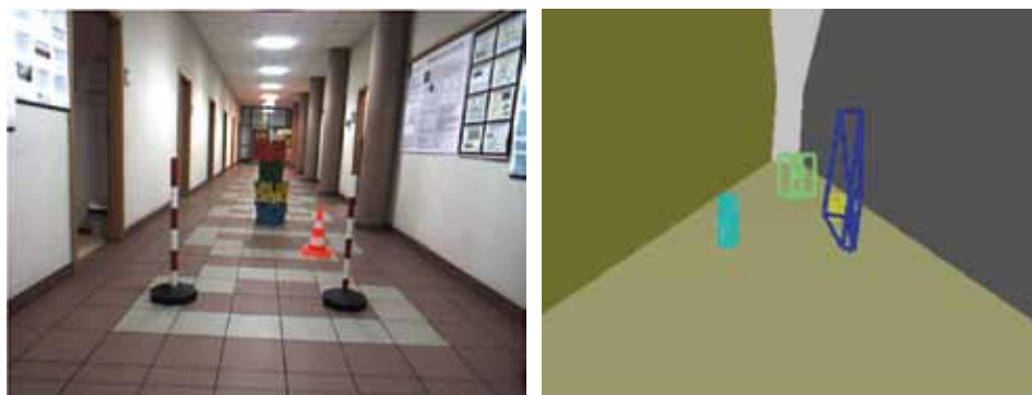
Rys. 5.9. Obraz sceny trójwymiarowej (z lewej) i model komputerowy utworzony do celów prezentacji dźwiękowej (z prawej)
