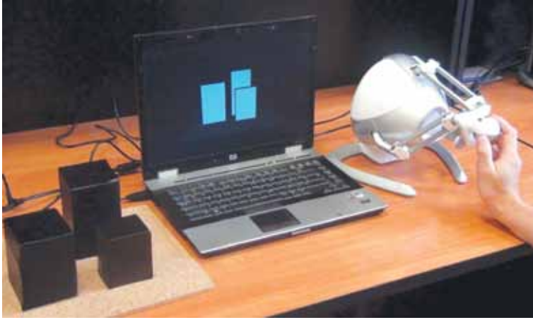
Rys. 4.22. Zdjęcie stanowiska do nauki obsługi interfejsu haptycznego; z lewej model kartonowy sceny, w środku model komputerowy sceny trójwymiarowej i z prawej interfejs haptyczny symulujący zaprogramowaną wirtualną scenę
