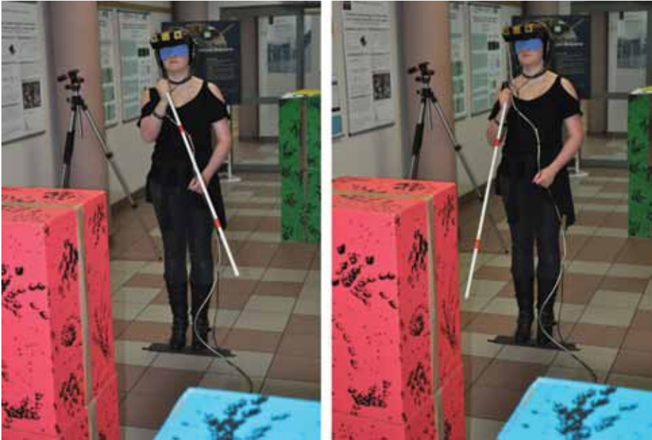
Rys. 5.14. Przebieg testu spostrzegania kierunku przeszkód, uczestnik testu białą laską wskazuje kolejno kierunki spostrzeganych przeszkód
