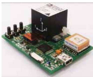
Rys. 3.11. Moduł elektroniczny zawierający trójosiowy czujnik przyspieszenia, trójosiowy żyroskop oraz odbiornik GPS (wykonano w Instytucie Elektroniki PŁ)
