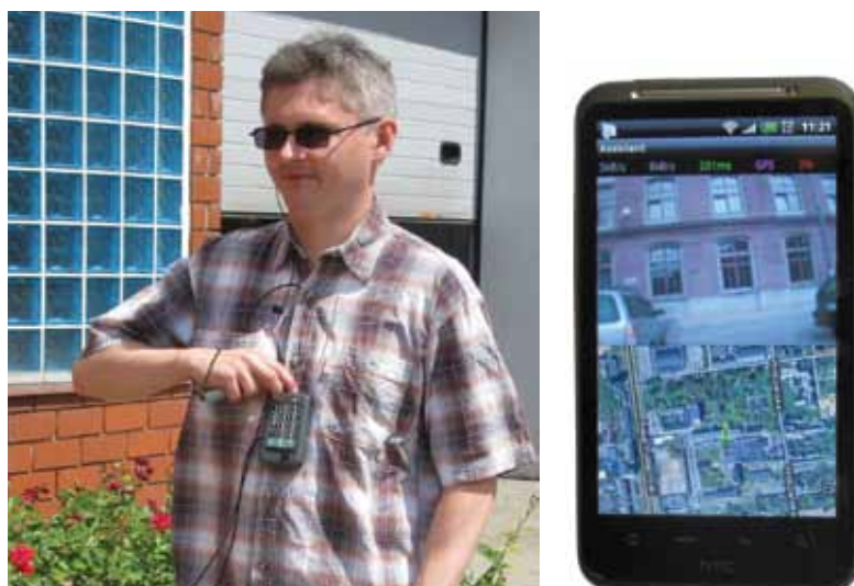
Rys. 5.26. Zdjęcie osoby niewidomej korzystającej z terminala mobilnego systemu oraz aplikacja terminala zdalnego przewodnika w wersji dla urządzenia mobilnego
