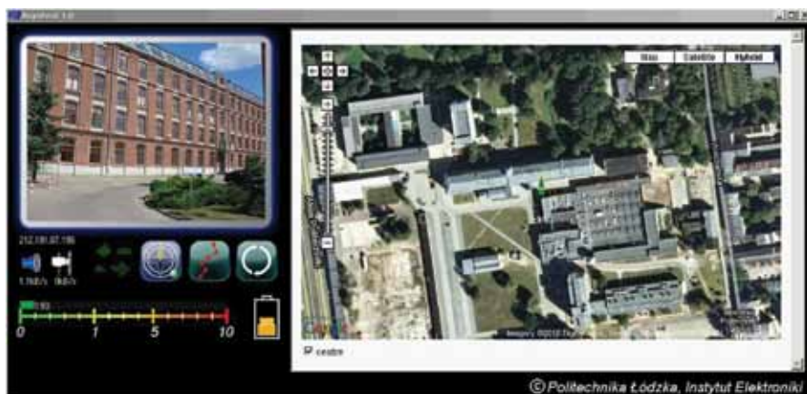
Rys. 5.25. Widok okna programu terminala zdalnego przewodnika (z lewej obraz przesłany z terminala mobilnego, z prawej mapa cyfrowa miasta z zaznaczonym zieloną strzałką położeniem terminala mobilnego)
