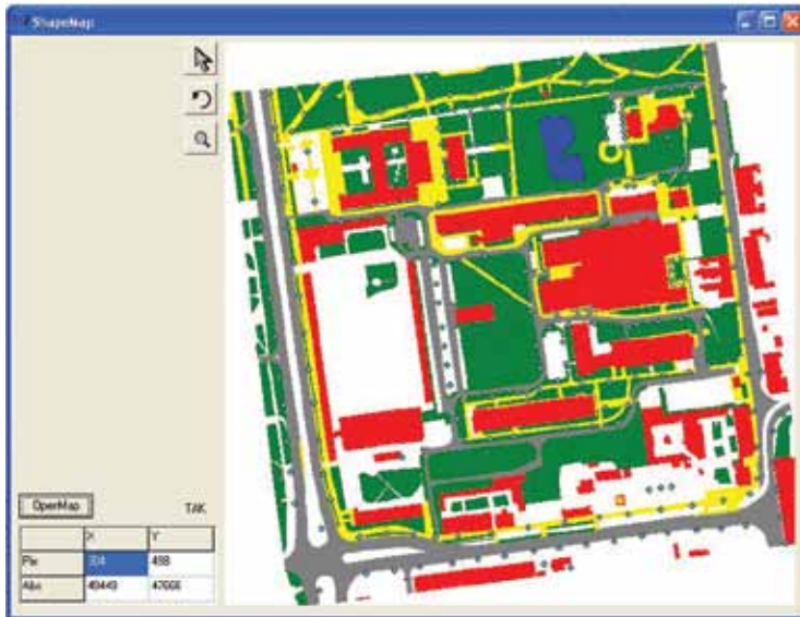
Rys. 3.6. Widok okna programu wyświetlającego mapę cyfrową (format Shape) z barwami przyporządkowanymi do różnego typu obiektów: czerwony – budynki, szary – jezdnie ulic, żółty – chodniki i ścieżki, zielony – trawniki, ciemno-niebieski – zbiorniki wodne, jasno-niebieski – latarnie, słupki
