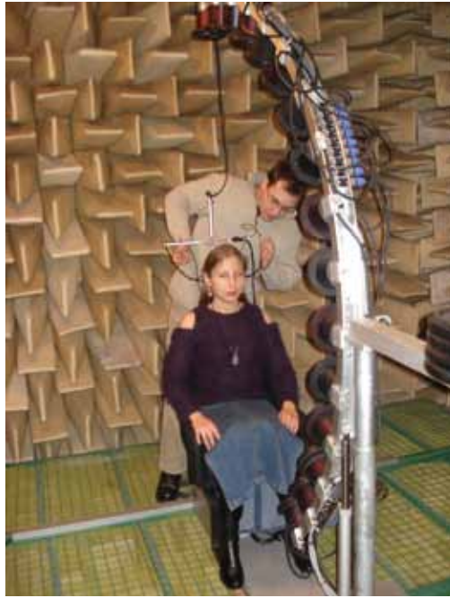
Rys. 4.13. Zdjęcie urządzenia do pomiaru charakterystyk akustycznych głowy (HRTF) wykonane w chwili przygotowania pomiaru
