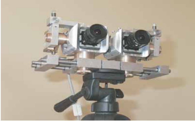
Rys. 2.18. Widok testowego układu stereowizyjnego o bazie B = 8 cm; zastosowano kamery cyfrowe Flea firmy Pointgrey ( www.pointgrey.com ); parametry kamery: matryca CCD o rozmiarze 1/3 cala i rozmiarze pojedynczej komórki (piksele): \Delta_x \cong 8,8 \mu\text{m} , maksymalna rozdzielczość: 1024 \times 768 , maksymalna szybkość klatkowa: 30 fps ( frames per second ), ogniskowa obiektywu: f = 3,5 mm
