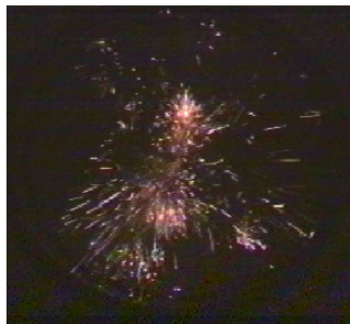
Rys. 5.1. Tory poruszających się cząstek spalanego czarnego prochu w nieruchomej komorze spalania. Czas ekspozycji 1/250s
