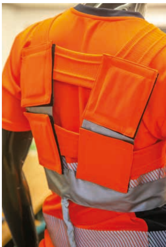
Prototyp odzieży ochronnej z funkcją aktywnego chłodzenia – tył
