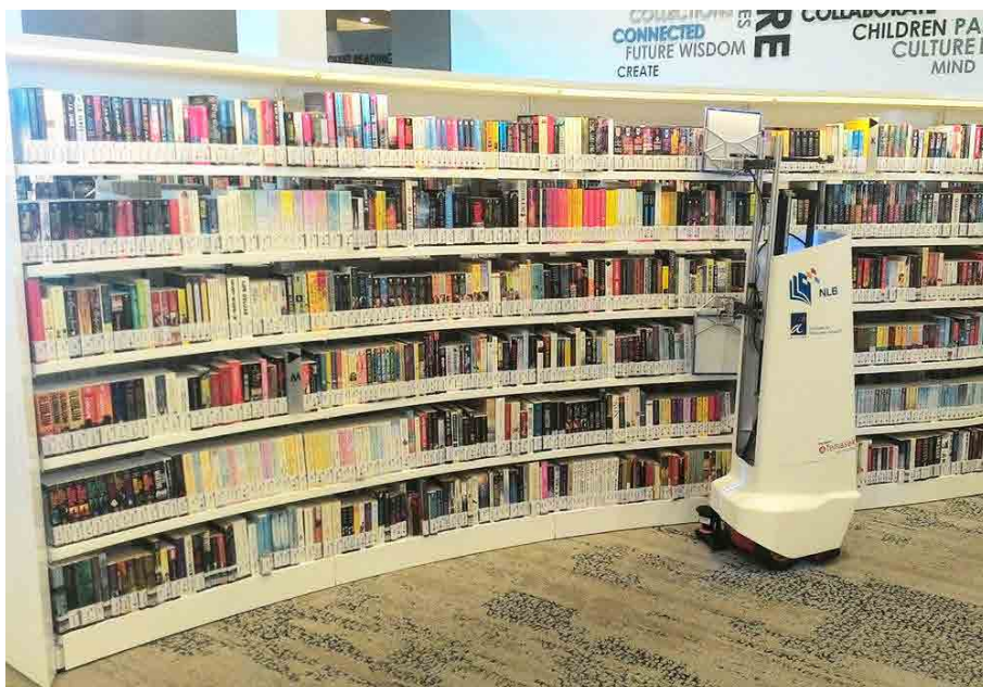
Rysunek 32. Robot AuRoSS pomagający w odszukiwaniu książek nieprawidłowo odłożonych na półki
