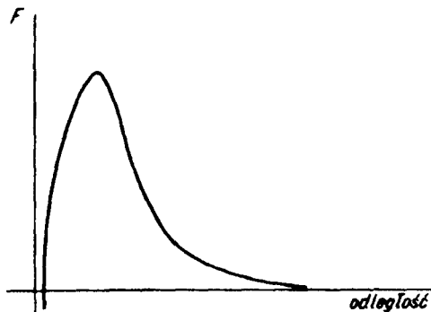
Rys. 97. Zależność sił międzycząsteczkowych od odległości
