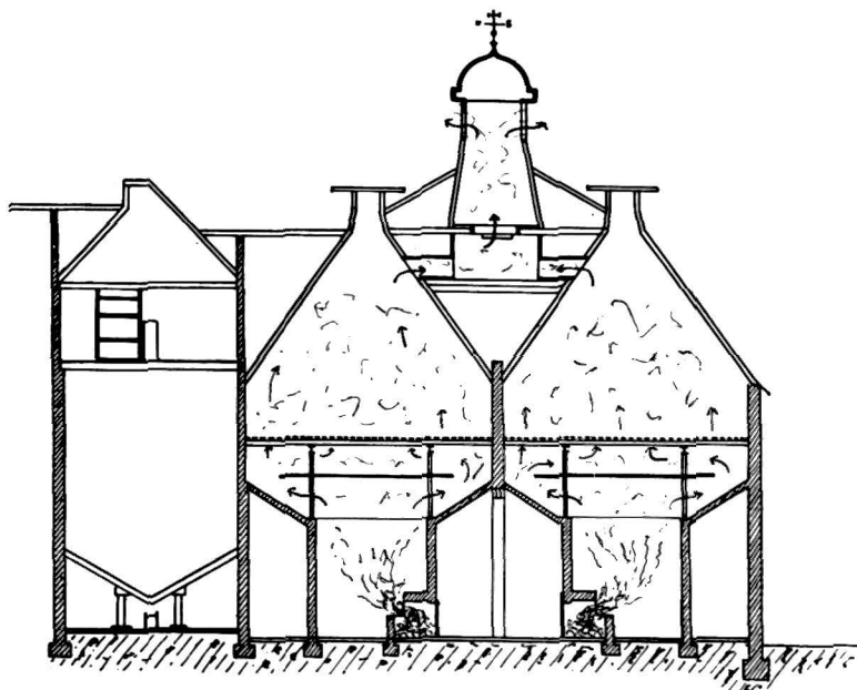
Abb. 59. Einhordendarre mit offener Feuerung als Doppelanlage
