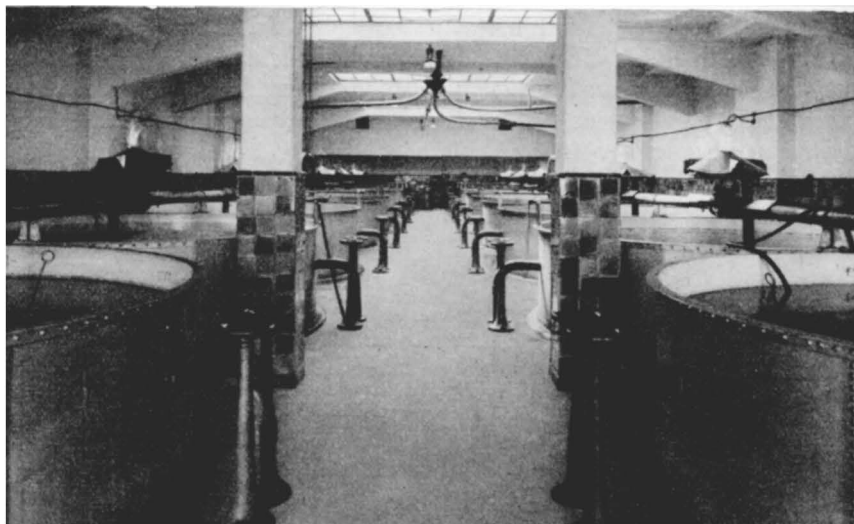
Abb. 24. Neuzeltliche Welchanlage mit 18 Welchbottichen zu je 12 000 kg Gerste
