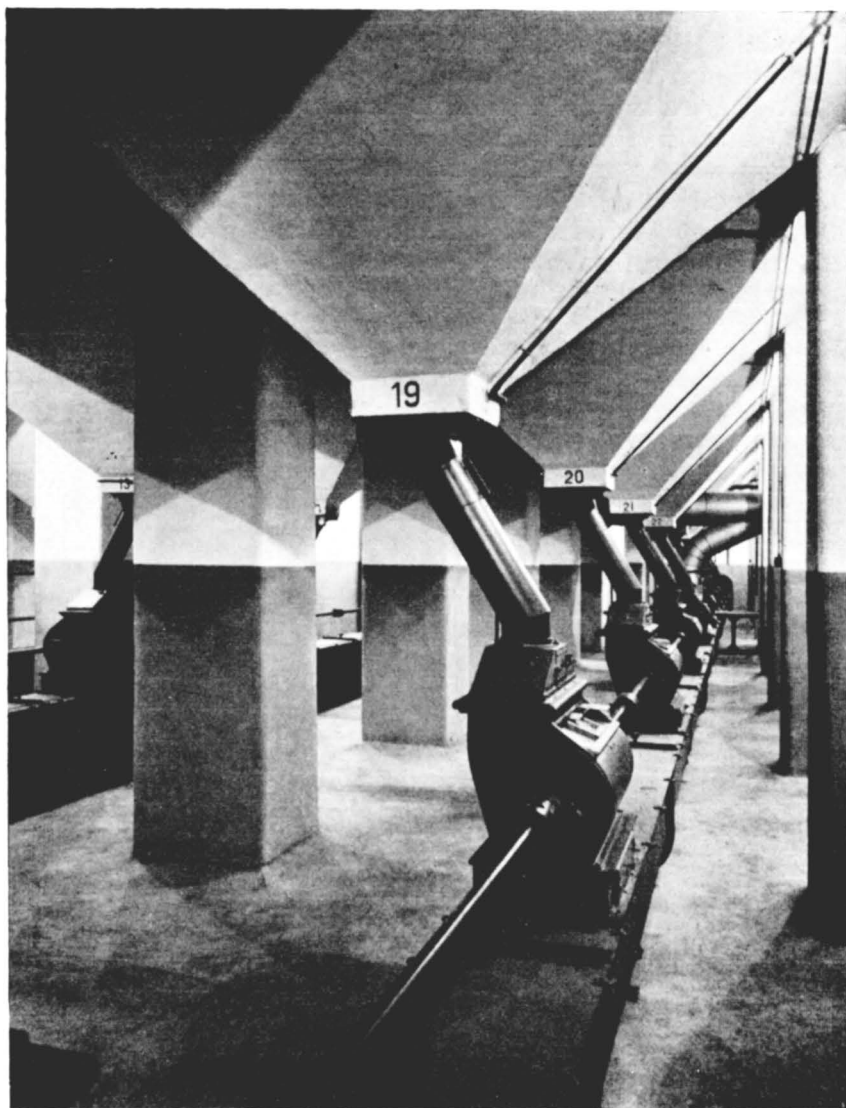
Abb. 106. Malzsiloanlage mit 24 Silos aus Zement und Verschneid-Vorrichtungen
