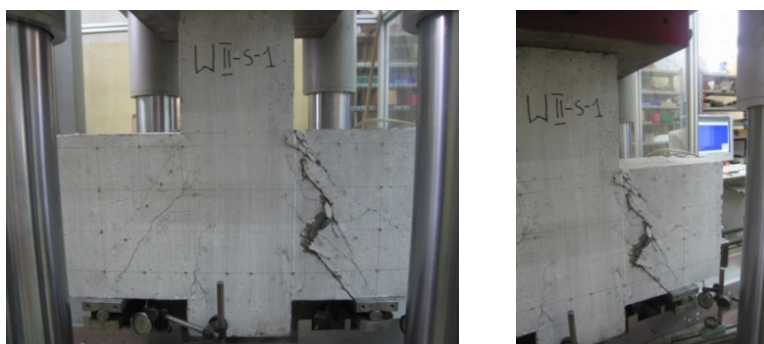
Rys. 10. Wspornik WII-S-1 ( a_F/d = 0,6 ) po zniszczeniu
