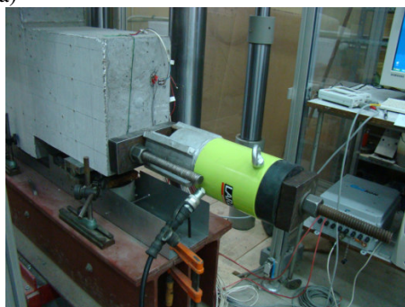
Rys. 3. Wsporniki na stanowisku badawczym podczas sprężania: a) WI-S-1, b) WIII-S-1
