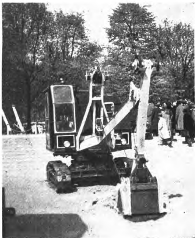
Rys. 2. Koparka uniwersalna E-252 o pojemności łyżki 0,25 m 3 .
