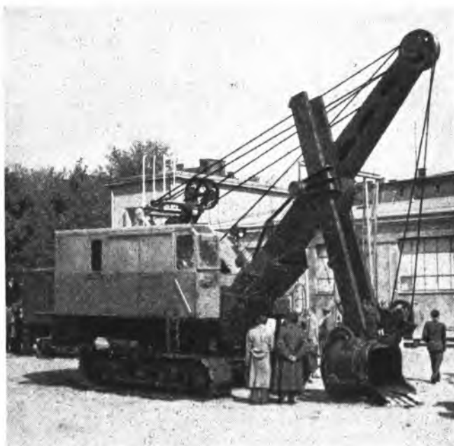
Rys. 3. Koparka typ E-1003 o pojemności łyżki 1 m 3 . Widoczne wysunięcie kabiny dla obsługującego pulpitu sterowniczy, w celu lepszej widoczności.
