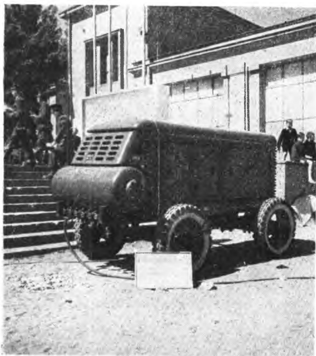
Rys. 12. Przewoźna sprężarka elektryczna produkcji radzieckiej o wydajności powietrza 5 \text{ m}^3/\text{min} .
