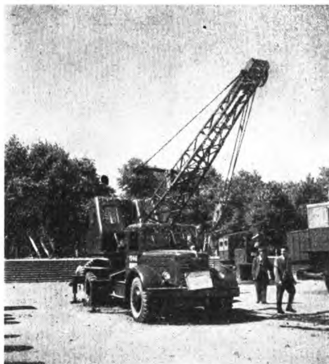
Rys. 14. Dźwig samochodowy „Janwarc” o nośności 5 ton, umieszczony na podwoziu ZIS.
