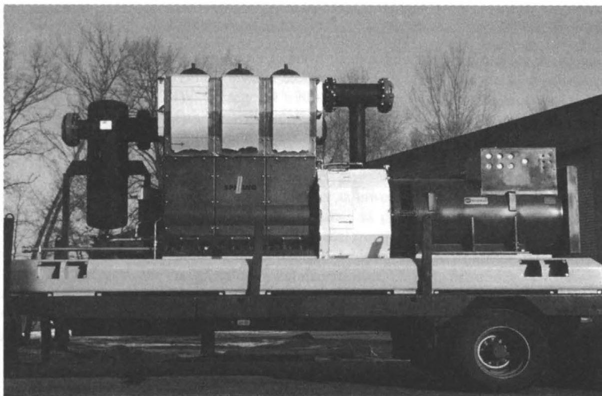
Fot. 6. 500 \text{ kW}_{el} – Silnik parowy z generatorem
