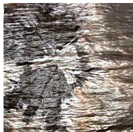
Rys. 3.4. Tkanina pokryta cienkimi powłokami metalicznymi niklu i miedzi
