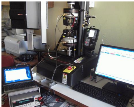
Fot. 3. Stanowisko do badania czułości na odkształcenia mechaniczne [6]
