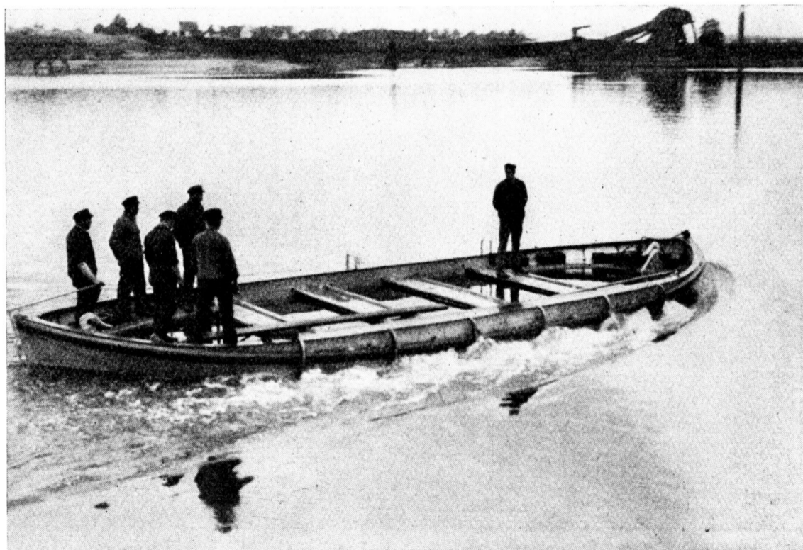
Abb. 14. Das mit einem Eisengewicht entsprechend 145 Personen belastete und voll Wasser gefüllte Boot macht mit dem eingekapselten, unter Wasser befindlichen Motor eine Fahrt.
