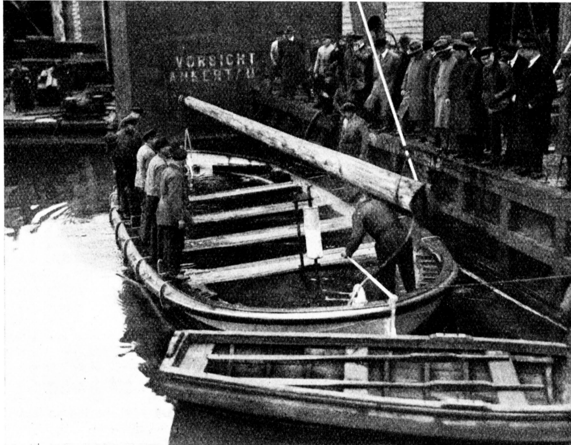
Abb. 13. Das Boot unter Abb. 12 wird durch 8 auf einer Seite stehende Personen belastet, wobei nur eine geringfügige Krängung auftritt.
