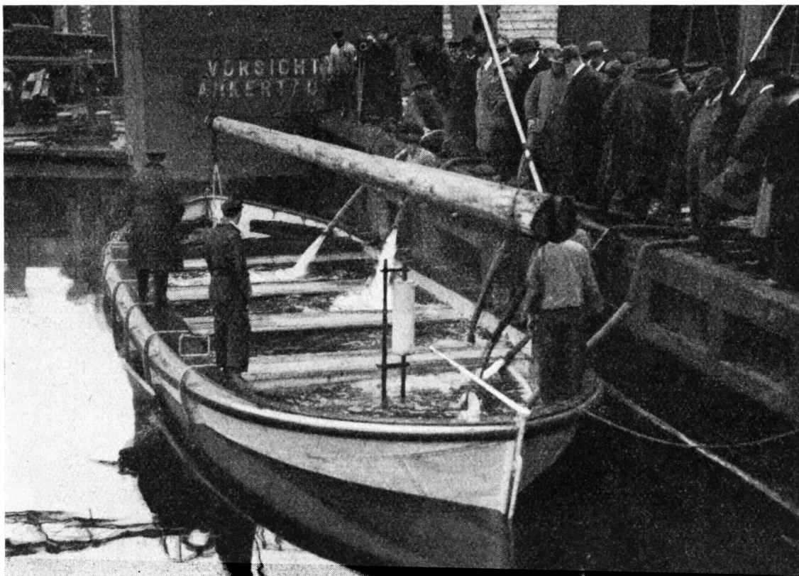
Abb. 12. Das mit einem Eisengewicht entsprechend 145 Personen belastete Boot wird bis oben voll Wasser gefüllt.
