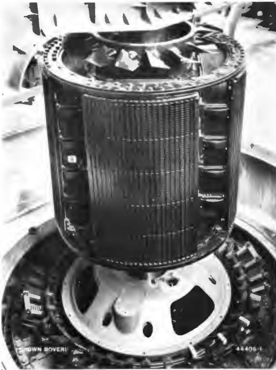
Abb. 6 — Polrad eines 18 000-kVA-Einphasengenerators beim Einfahren in den Stator
