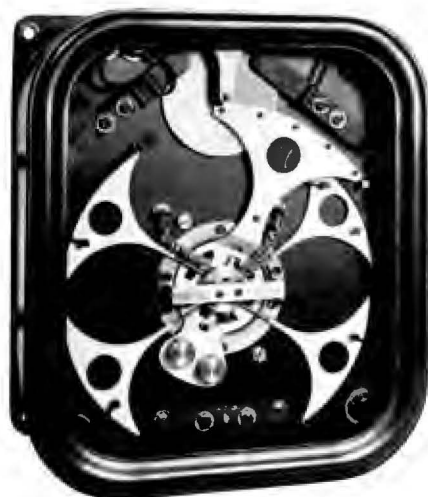
Abb. 2 — Der erste Wälzsektorregler der Welt aus dem Jahre 1907
