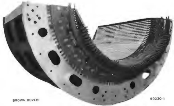
Abb. 10 — Statorhälfte mit eingebauter Zweistabwicklung Die Spulenköpfe sind auf zwei kräftige Ringe abgestützt.
