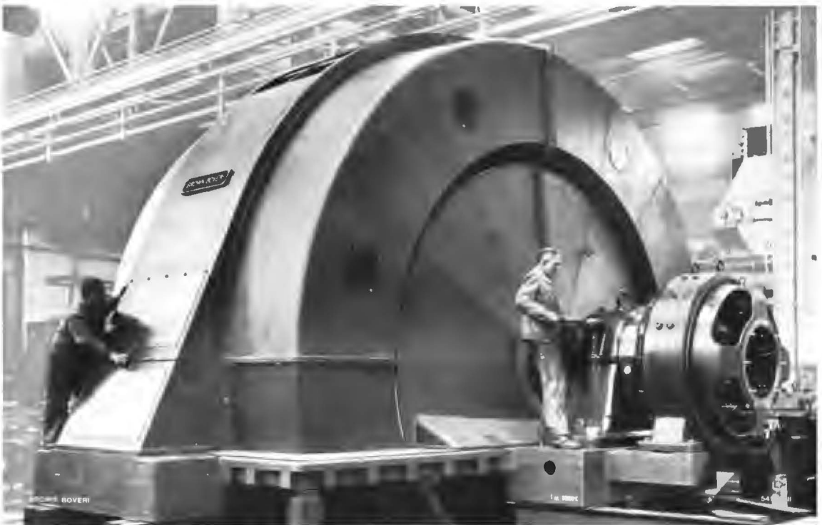
Abb. 9 — Stator eines Dreiphasengenerators von 24 500 kVA bei 300 U/min und 25 Hz mit angebauten Verschaltungen
