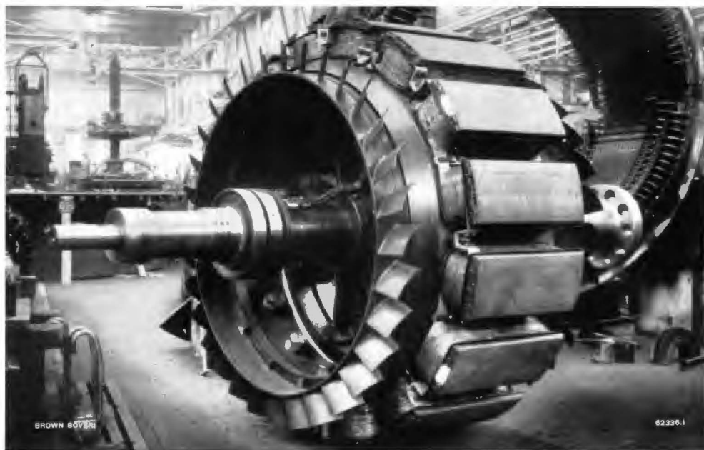
Abb. 3 Polrad eines horizontalachsigen Drehstromgenerators von 6000 kVA, \cos \varphi = 0,8 , 375 U/min, 50 Hz, 6600 \text{ V} \pm 9\% der Zentrale Rozadio der Sociedad Saltos del Nansa (Spanien)
