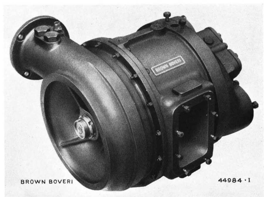
Abb. 11. — Aufladegruppe (Gebläse und Abgasturbine) zur Aufladung eines Dieselmotors nach dem Büchi-Verfahren von 100 auf 160 PS. Drehzahl max. 35 000 U/min.
